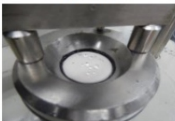
Penetración del agua
